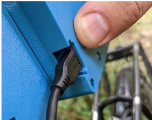
Wenn das Ladegerät angeschlossen ist, leuchtet eine rote Leuchtdiode. Eine blaue Leuchtdiode signalisiert, dass der Akku vollgeladen ist. Das Laden über eine Powerbank hat sich als praktische Variante erwiesen, bei der man den OBS am Fahrrad lassen kann bzw. nicht extra an eine Steckdose zum Laden muss. Unbeobachtetes Laden über Nacht sollte vermieden werden.
