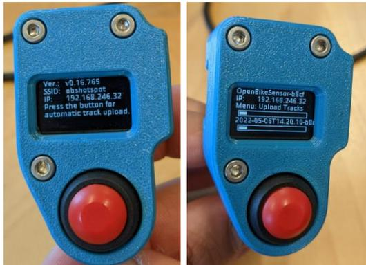
Zum Upload kann der OBS im Konfigurationsmodus (neu-)gestartet werden (Halten des Druckknopfes am Display während der Einschalter betätigt wird). Und anschließend durch langes Drücken den API-Upload starten. Es werden alle Files, die noch nicht auf dem Portal sind, hochgeladen. Dann sieht man den Fortschritt des Uploads auf dem Display.
