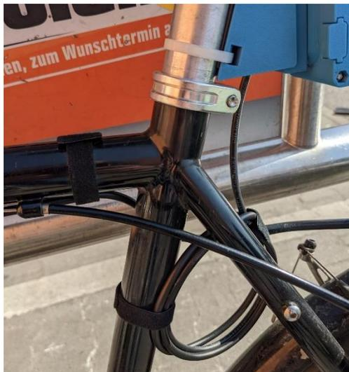
Das Kabel sollte so verlegt werden, dass während der Fahrt die Sicherheit nicht beeinträchtigt ist. Es kann mit 2-3 Klettbändern oder Reflektor-Klemmbändern gesichert werden.
