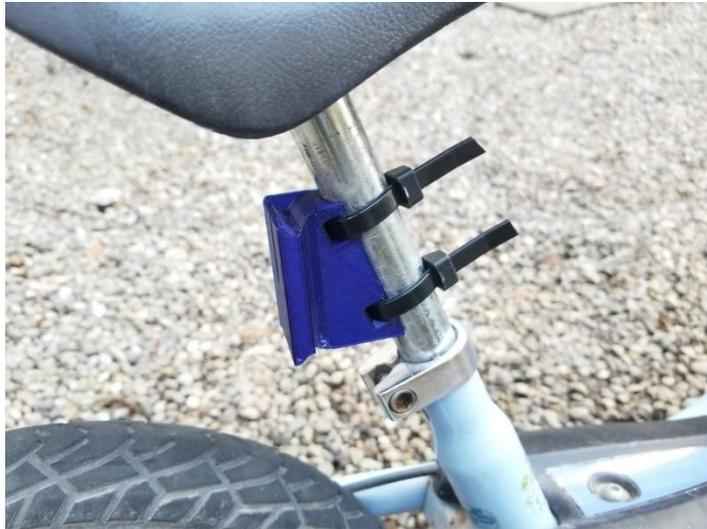
Die „Standardhalterung“ für das Hauptgerät wird mittels zweier Kabelbinder (max. 8mm breit) an der Sattelstütze befestigt. Zur Verdrehsicherung kann ein Stück Isolierband oder Fahrradschlauch zwischen Sattelstütze und Halterung befestigt werden.
