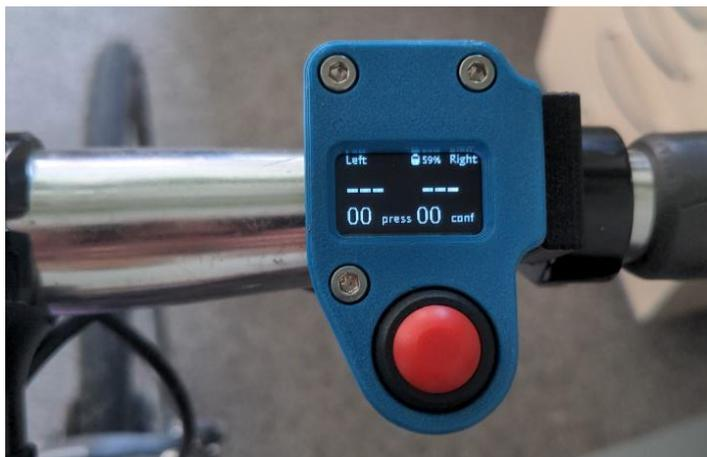
Wenn der OBS in den Messmodus wechselt, ist das Gerät mit den Satelliten verbunden. Achtung: Wenn man auf den Taster drückt bevor die GPS-Verbindung steht, wird direkt in den Messmodus gewechselt, allerdings ohne GPS-Empfang.
