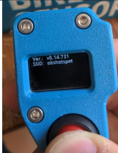
OBS versucht, sich im Konfigurationsmodus mit dem voreingestellten WLAN *obshotspot* zu verbinden.
