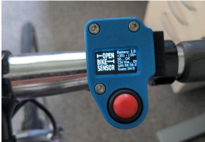
Das Gerät im Freien am Kippschalter einschalten und auf den korrekten GPS-Empfang warten. Es kann eine Weile dauern, bis die GPS-Verbindung steht. Genauso wie bei anderen GPS-Geräten.
