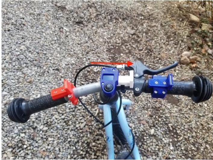
Zur Montage wird das Display auf die Lenkerhalterung geschoben.
