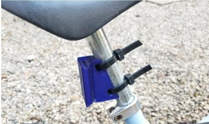
Die Halterung für das Hauptgerät wird mittels zweier Kabelbindern (max 8mm breit) an der Sattelstütze befestigt. Zur Verdrehsicherung kann ein Stück Isolierband oder Fahrradschlauch zwischen Sattelstütze und Halterung befestigt werden.
